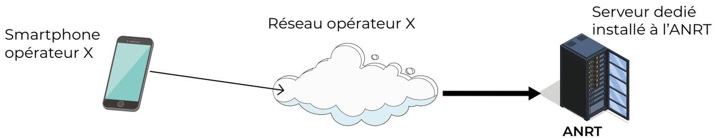
Les mesures des performances de la connexion Internet de chaque opérateur ainsi que des services d'accès au serveur qui lui sont affectés sont effectuées via un lien en fibre optique à débit garanti supérieur au plus grand débit Internet mobile des 3 opérateurs de façon à ne présenter aucune contrainte technique aux mesures.
